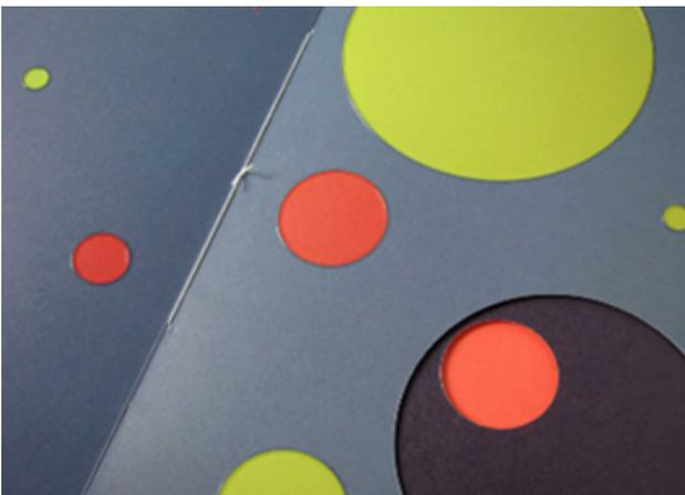
Abbildung 2: Fadenheftung mit flachem Bund in der Mitte
